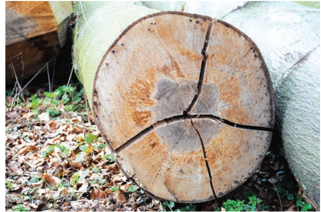
Opensplijten van de stam door de aanwezigheid van trekhout bij beuk
