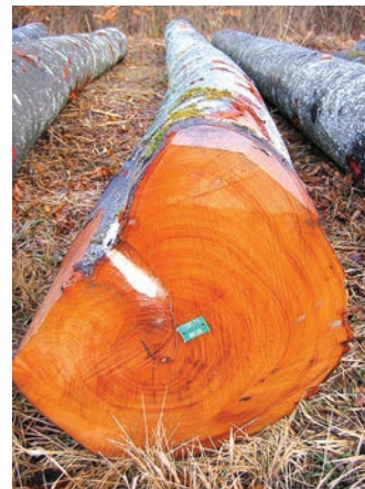
Ovaliteit van de stamdoorsnede
