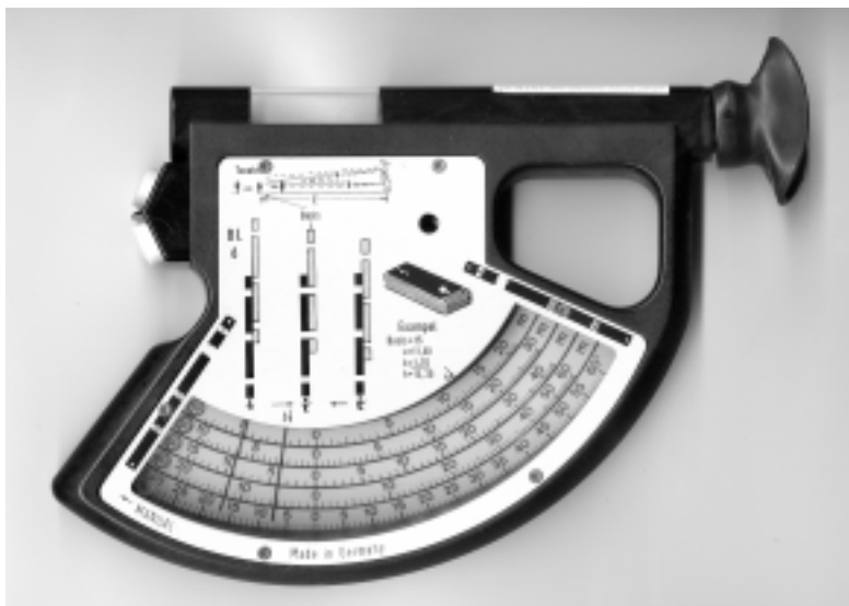
figuur 8 - Hoogtemeter van Blume-Leiss.
